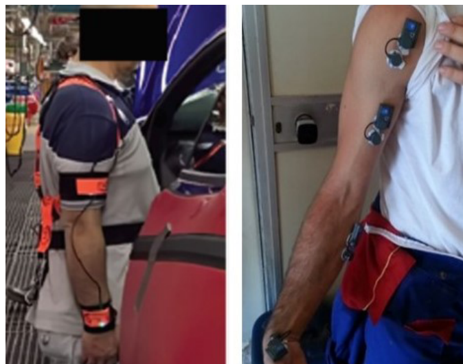
Figura 1: Lavoratore che indossa a sinistra sensori inerziali e a destra sensori per l'EMGs.
