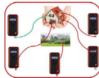
Figura 2: Schema esemplificativo della intra-calibrazione degli analizzatori miniaturizzati propedeutica al loro utilizzo in configurazione di "flotta" all'interno di diversi ambienti di uno stesso edificio.
