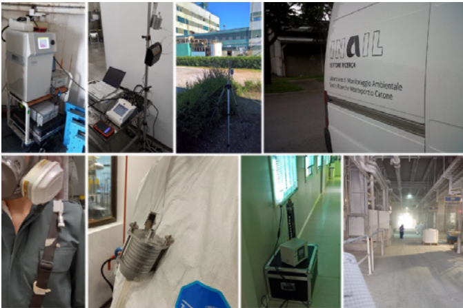
Figura 2: Strumenti di misura e campionatori ambientali e personali a disposizione del Dimeila, posizionati in ambienti di lavoro.
